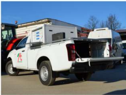
Nadstavba pre servis
